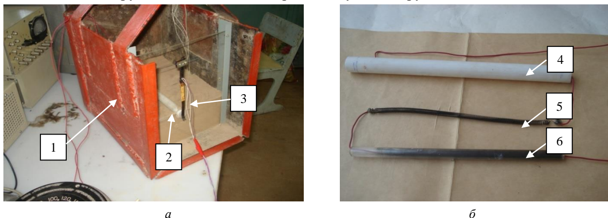
Рис.1. Каретка с моделью трубы, расположенной на грунтовом основании (а); и модель трубы с системой нагрева (б): 1 – каретка центрифуги; 2,4 – модели трубы; 3 – датчик перемещения; 5 – спираль; 6 – кварцевая трубка
